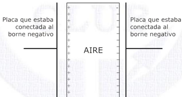
Pero, al llegar aquí no pueden seguir su camino puesto que se encuentran con el circuito abierto (está el dieléctrico) y por ello la corriente eléctrica cesa inmediatamente y el instrumento deja de indicar. La placa conectada al borne positivo de la batería ha quedado con un defecto de electrones es decir con carga positiva y la placa conectada al borne negativo de la batería ha quedado con un exceso de electrones es decir que ha quedado con carga negativa.
